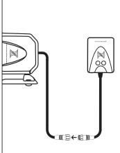
STEP 4: CONNECT COR PUMP TO THE COR DRIVER
